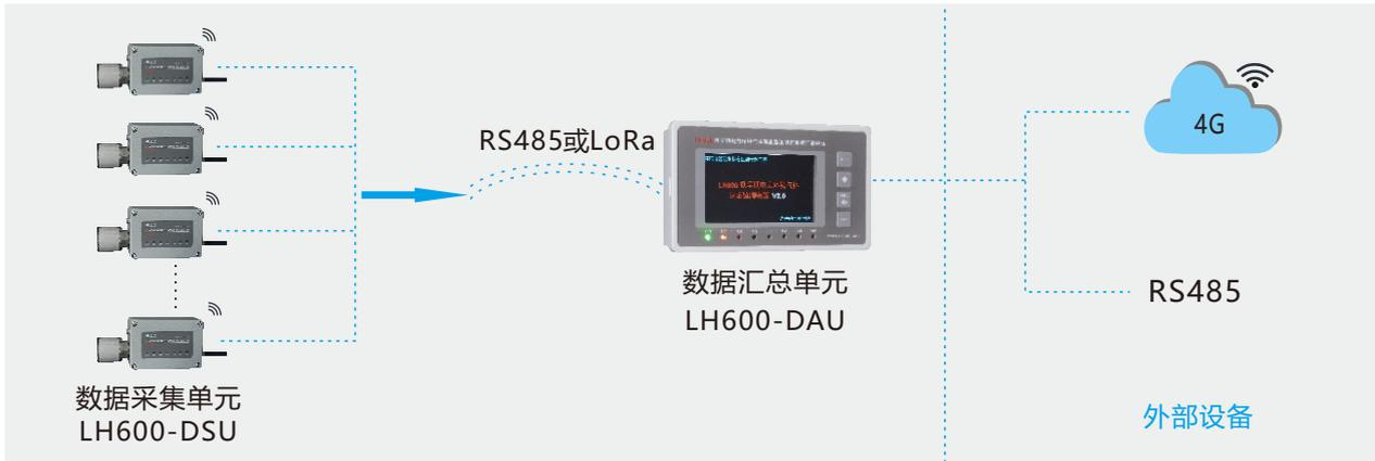
图1 LH600基本配置示意图 (数据采集单元+数据汇总单元,并通过后者与外部通讯)
